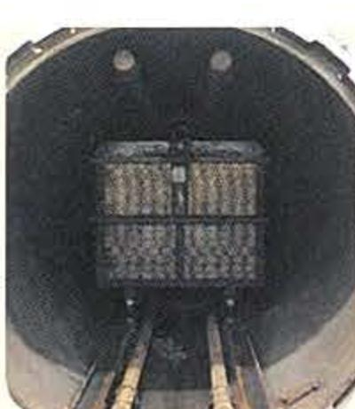
⑤缶の蓋がキチンとしまってあるか検査した後、洗浄し、釜で殺菌・加熱します。
