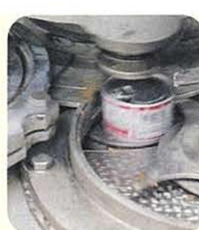
④調味液を充填し、缶に蓋をかぶせ、真空状態にして蓋を閉めます。
