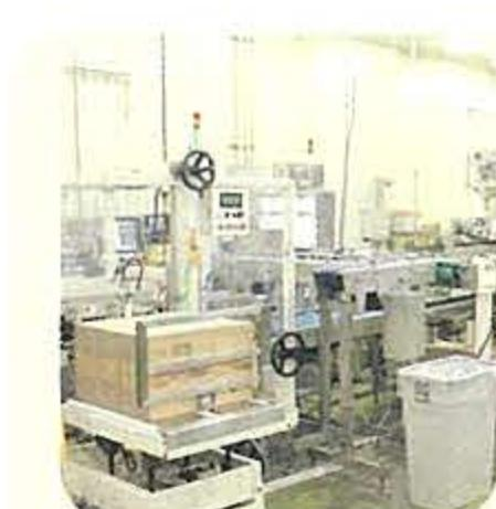
⑥殺菌・加熱した缶への印字や違う缶が混じっていないか等検査し、箱詰めして出荷します。
