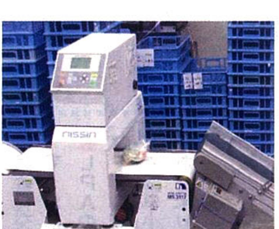
③二次冷却した麺は水を切って包装機で袋詰めされ、金属探知機を経て人の目でチェックします。
