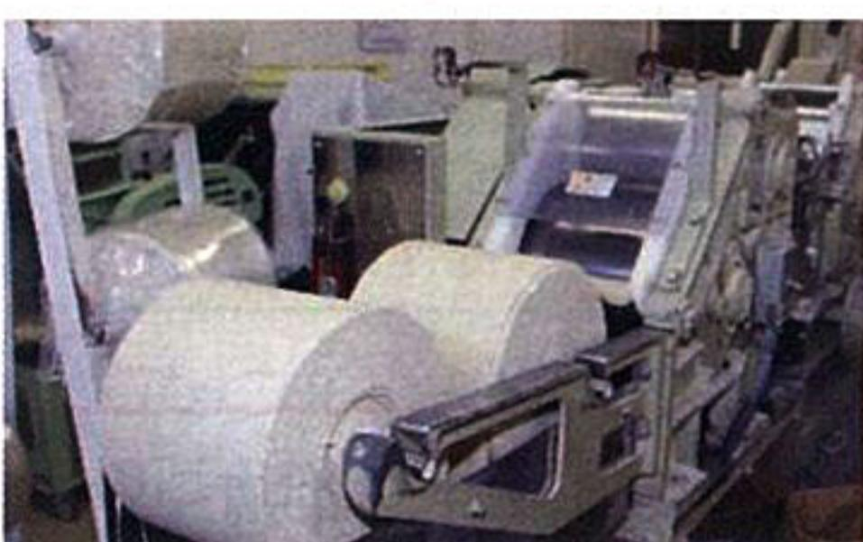
①そば粉を熱湯でこねて餅状にした「そばがき」にそば粉と小麦粉を加えてミキサーにかけ、ロール状の「麺帯」にして寝かせます。寝かせた「麺帯」は「圧延」により「麺線」を切り出します。
