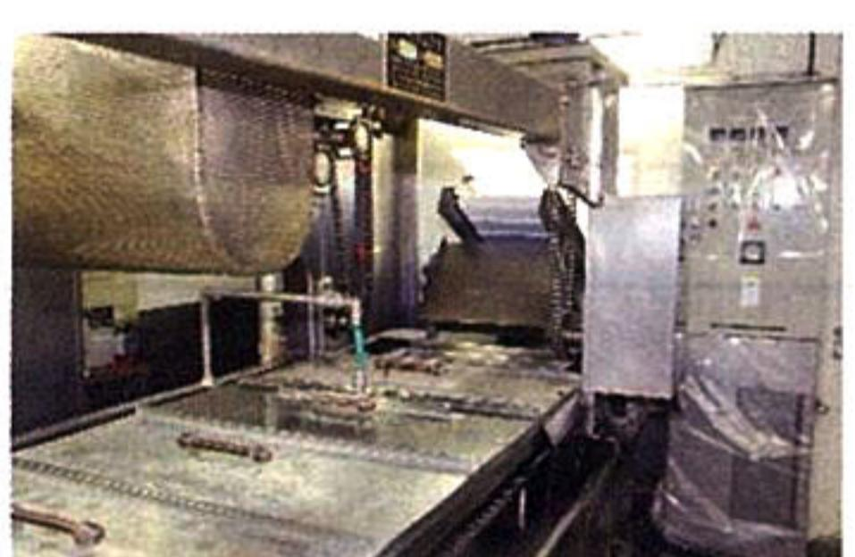
②①の麺は連続的に茹で釜に移動します。茹でた麺は水槽に移し、粗熱を取ってエアーによる泡で洗浄。その後、計量機で1袋分に分け、冷水で二次冷却します。
