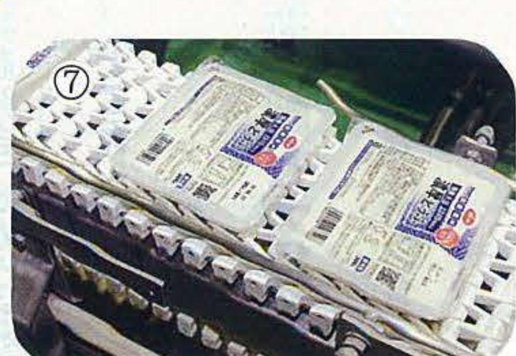
容器に充てん(⑥)。その後、フィルムで封をし(⑦)、加熱して固め、冷却します。最後に、X線検査装置等の検査機器と、人の目によるチェックを経て製品となります
