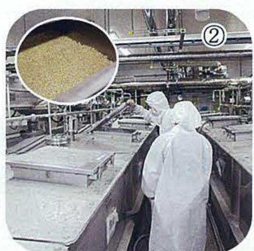
搬入された原料大豆は研磨機(①)で磨き、きれいにしてから②の浸漬槽(水につけて水分を吸収させるタンク)に送られます
