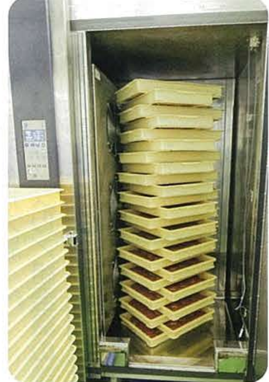
④並べたハンバーグをプラスチックラー（急速冷却・急速冷凍できる機械）に入れ、鮮度を保ったまま急速冷凍します。表面が白っぽくなる場合がありますが、冷凍焼けではなくしっかり冷凍できている証拠です。
