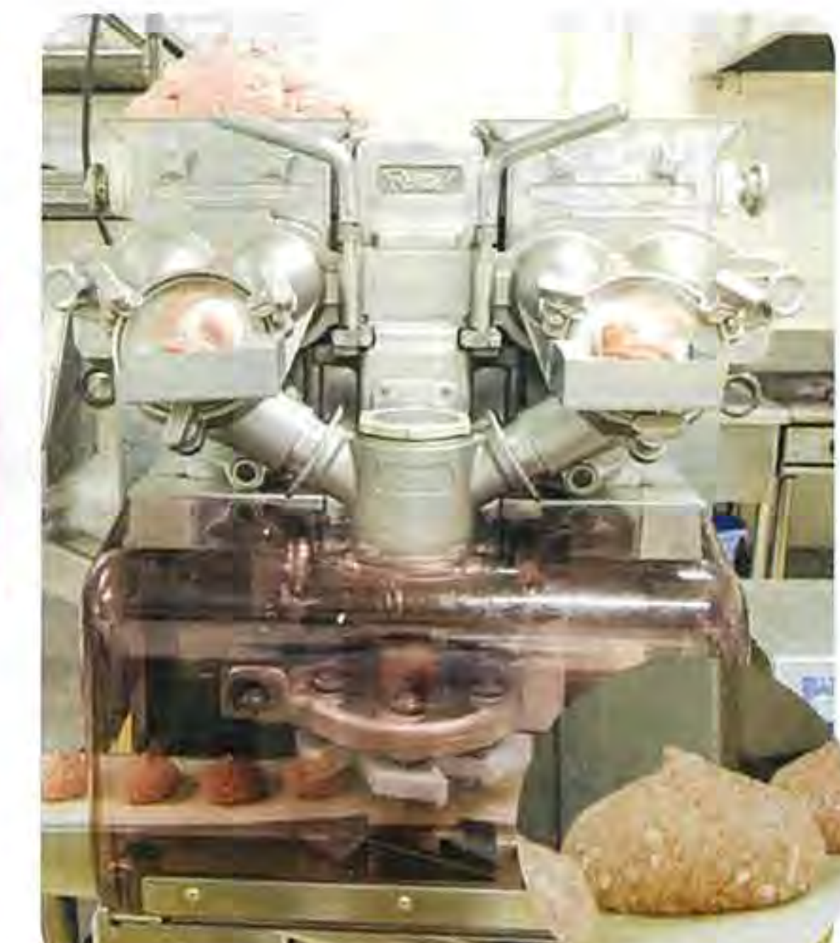
②それぞれを包餡機「火星」に入れ、粗目のタネを細目のタネで包んだお饅頭と同じ構造のハンバーグを作ります。機械の中で、2重構造(内側:粗目、外側:細目)の棒を作り、外側のタネでおおうように切ります。
