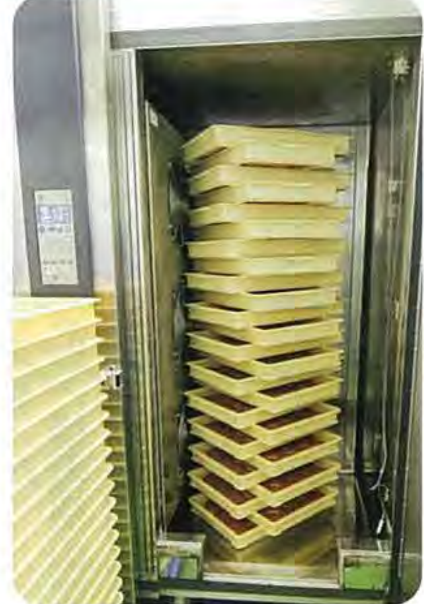
④並べたハンバーグをプラスチックラ(急速冷却・急速冷凍できる機械)に入れ、鮮度を保ったまま急速冷凍します。表面が白っぽくなる場合がありますが、冷凍焼けではなくしっかり冷凍できている証拠です。
