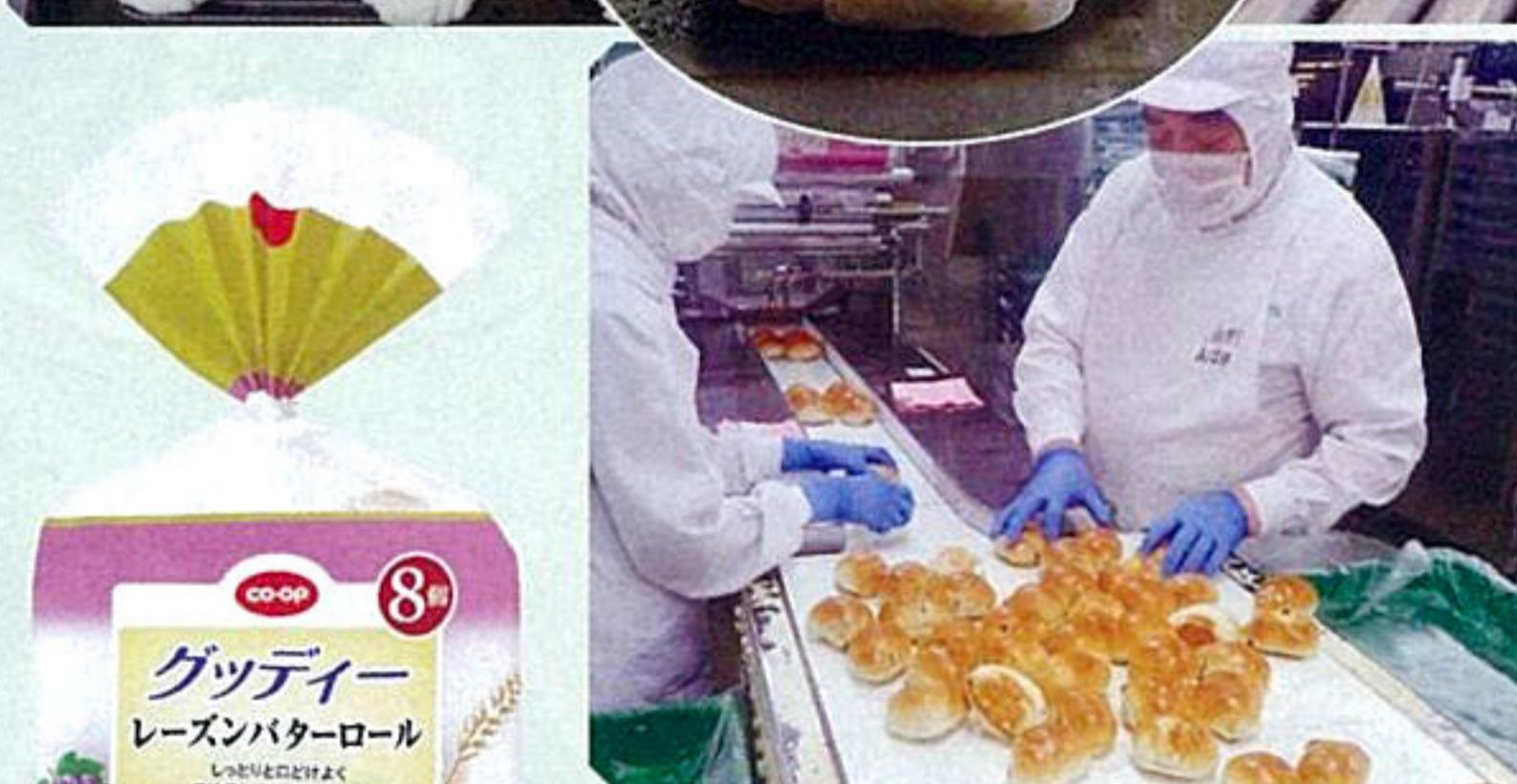
◆食パンとは工程が異なるロールパンは盛岡工場でつくられています。製造は機械の切り替えの関係から夜中に(一番最初に)行われるため、掲載はメーカーの提供写真です。分割して丸めた生地を休ませ、のばしてらっきょう形に丸め、その後、型に並べて(左上の写真)ホイロで二次発酵させ、オーブンで焼き上げます
