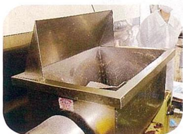
①写真の装置(機械)で、成形・カットして挽肉にした肉と他の原材料を加えてハンバーグの生地をつくります(挽肉は空気に触れると一気に発色するため、この工程の管理には非常に気を遣うそうです)
