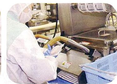
③出来上がったハンバーグを凍結し、真空パックします(形を保ったまま真空パックをする深絞りと呼ばれる機械) パックしたハンバーグを金属探知機等でチェックして完成です
