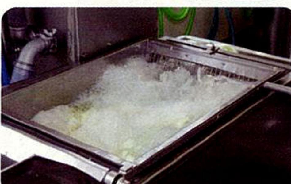
\*左は野菜を洗浄する装置。特にキャベツは葉が巻いているため、葉と葉の間に異物が混入しているケースもあるといいます。上の円内はキャベツを刻む機械。洗浄して1枚ずつはがし、洗浄装置にかけてからこの機械にかけ、その後、豚肉や他の野菜、調味料などとともにミキサーで混ぜ合わせて、具材が出来上がります
