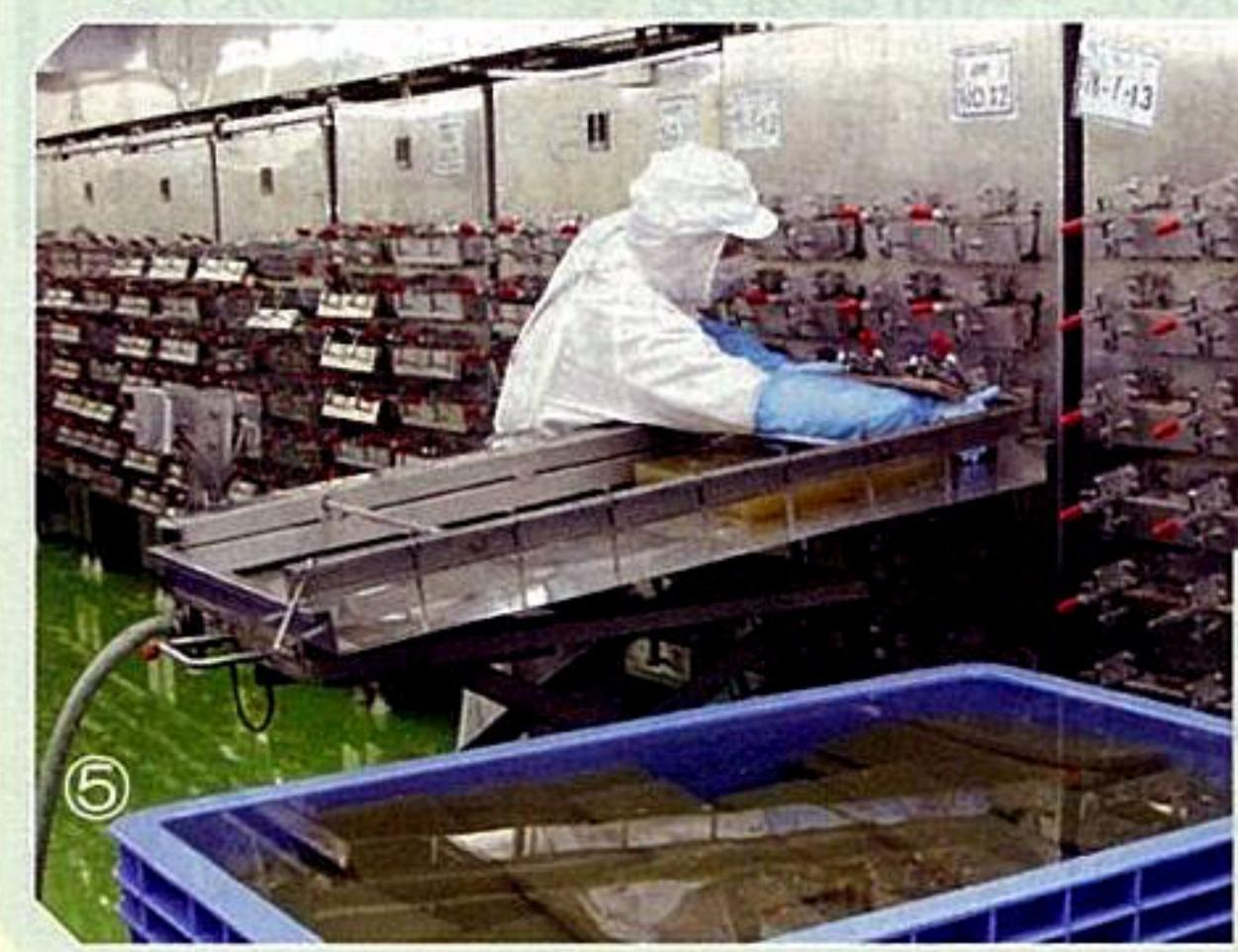
ところてんの大きな塊を冷却機から取り出し（写真⑤）、機械の幅にカットして水槽に取ります。その後、パックに充てんする装置にセット（写真⑥）。たれのセット（写真⑦）以外は自動で行われます
