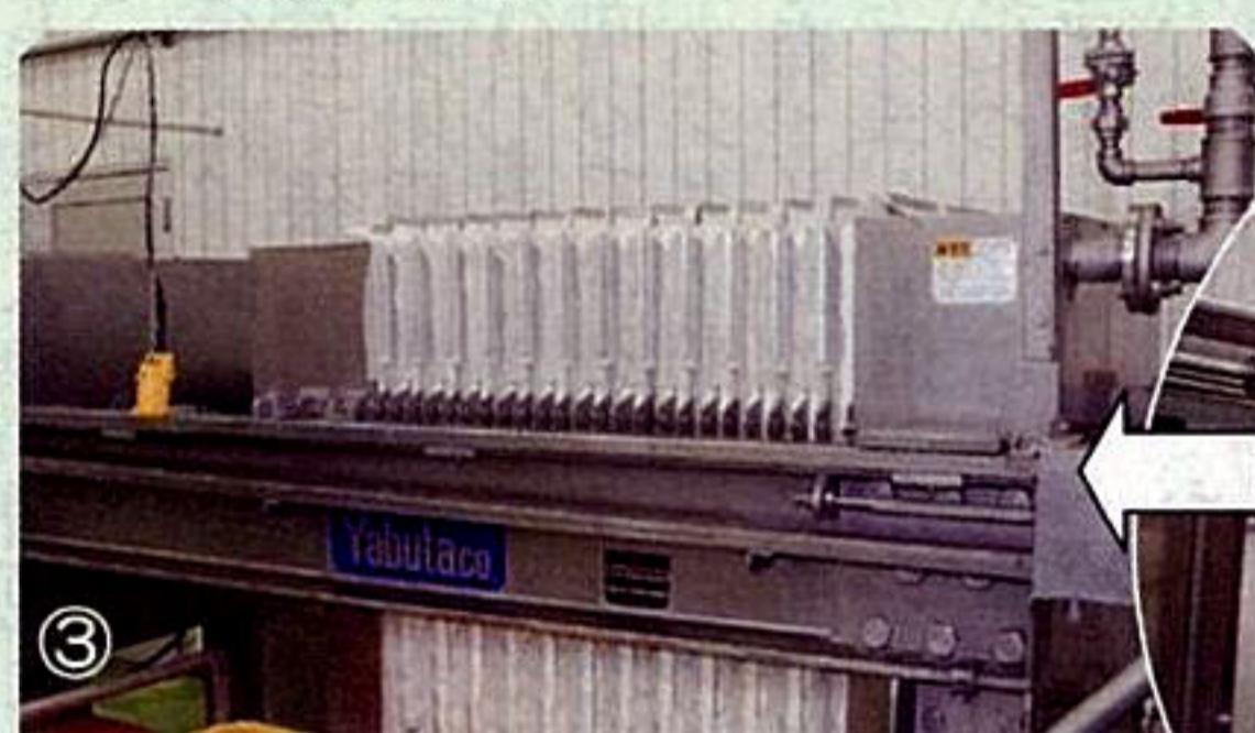
③天草を煮て得られた液から、きれいな煮汁だけを取り出すフィルタープレスと呼ばれるろ過装置。液に圧力をかけながら、何枚ものフィルターを通していきます／④中を水が循環しているという巨大な冷却機。セットされている型に③の液を流れ入れ、冷やして固めます
