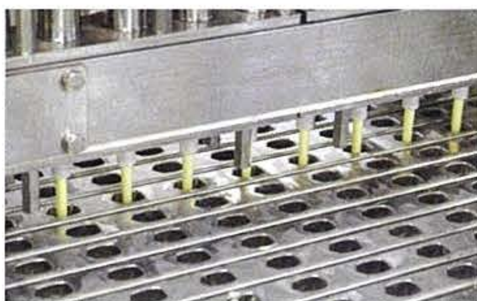
▲空気を含ませたアイスクリームミックスを型に充填する工程。金属の型の周りにも冷たい約-30℃のブライン液（塩化カルシウムの不凍液）を循環させアイスクリームミックスを冷やして固めます。
