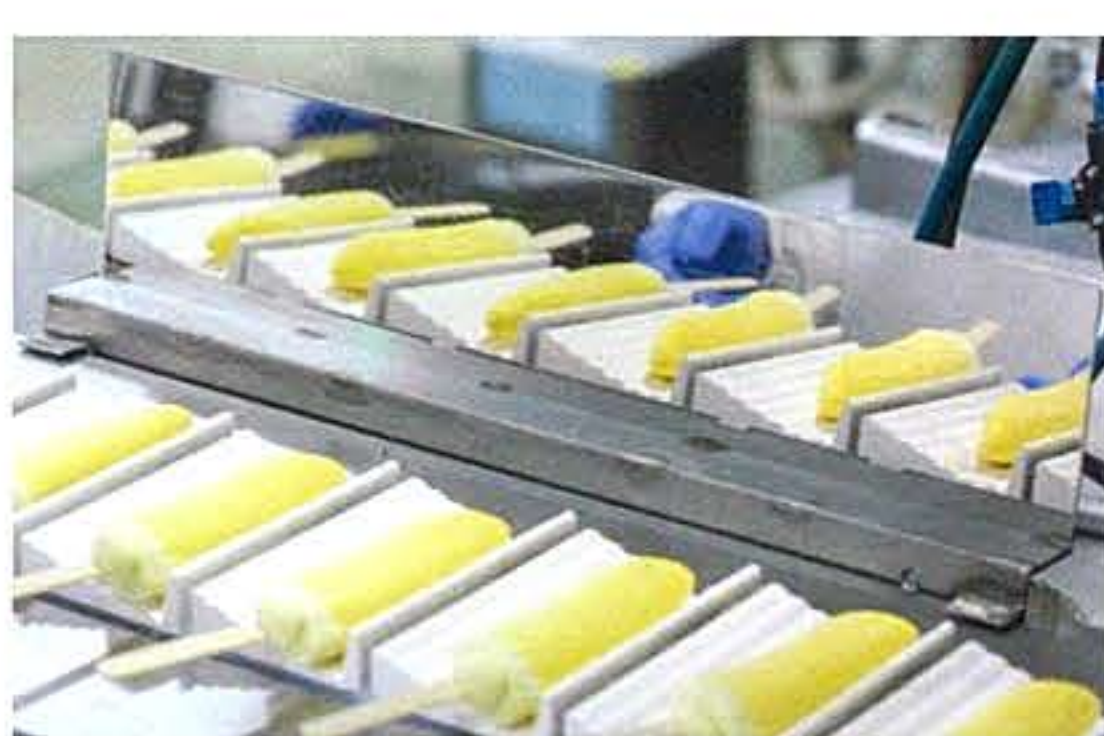
▲完成したバナナチョコアイスバーは、型から抜く際に先端が欠けてしまうことがあるため、鏡の前を通過させ人の目で先端部分が欠けていないかチェックします。欠けているものがあればラインから取り除きます。
