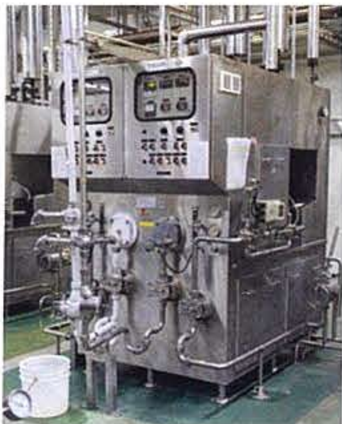
▲空気を含ませることでアイスをなめらかにする機械。高速で攪拌することで空気を含ませます。
