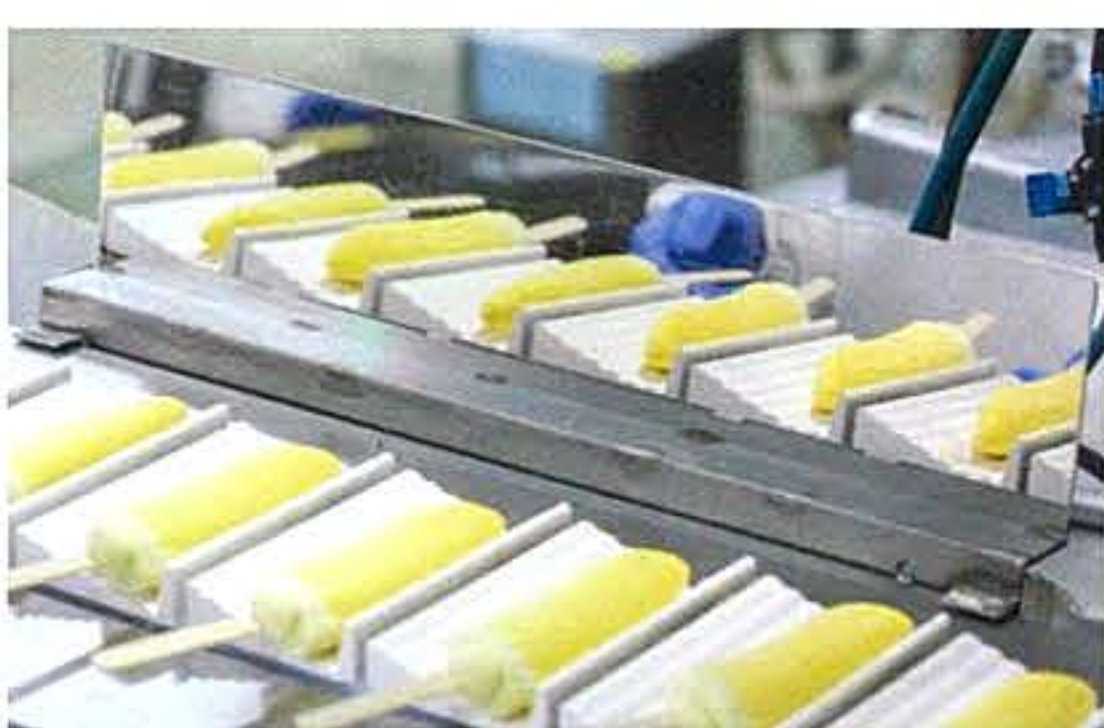
▲完成したバナナチョコアイスバーは、型から抜く際に先端が欠けてしまうことがあるため、鏡の前を通過させ人の目で先端部分が欠けてないかチェックします。欠けているものがあればラインから取り除きます。
