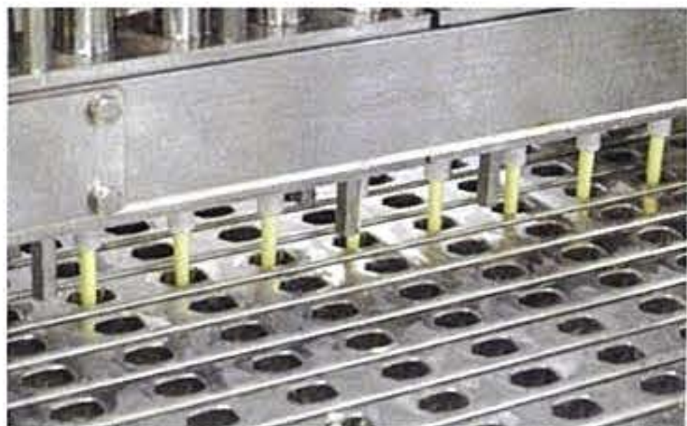
▲空気を含ませたアイスクリームミックスを型に充填する工程。金属の型の周りにとっても冷たい約-30℃のブライン液（塩化カルシウムの不凍液）を循環させアイスクリームミックスを冷やして固めます。
